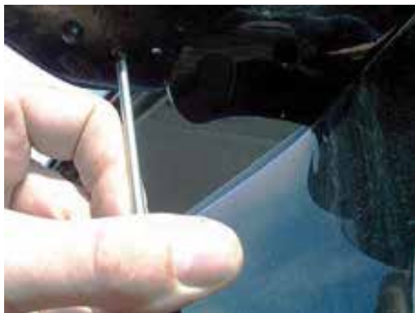
شکل ۱۷۵-۲- بازکردن پیچ پایین قاب بیرونی آینه
