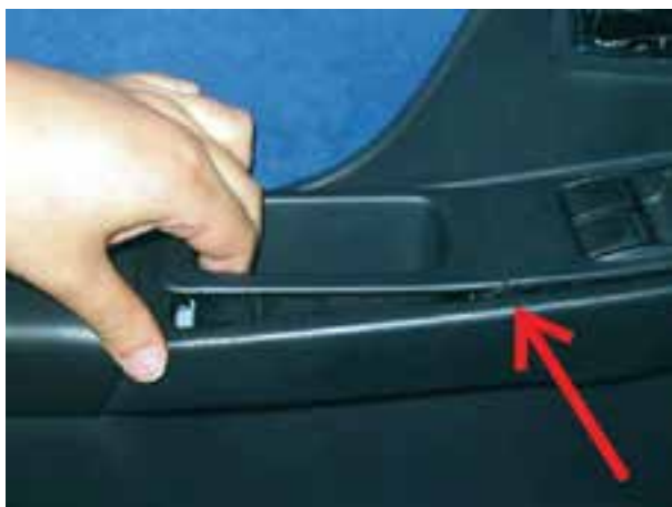
شکل ۱۸۳-۲- خارج نمودن قاب سوئیچ‌ها
