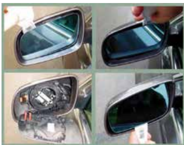
شکل ۱۶۷-۲- بیرون آوردن آینه از داخل قاب آن
