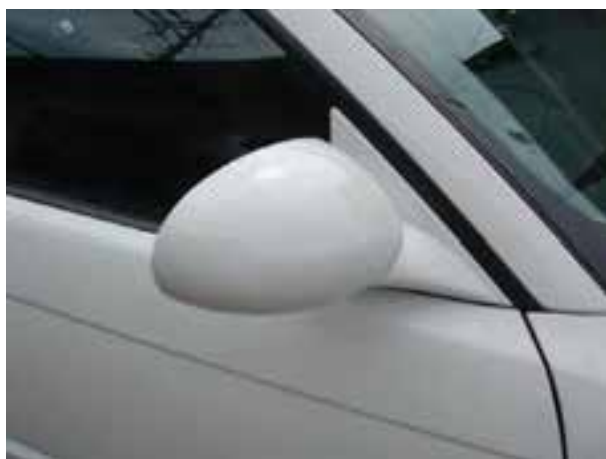
شکل ۱۵۸-۲- قاب آینه‌ی جانبی در یک نوع خودرو
