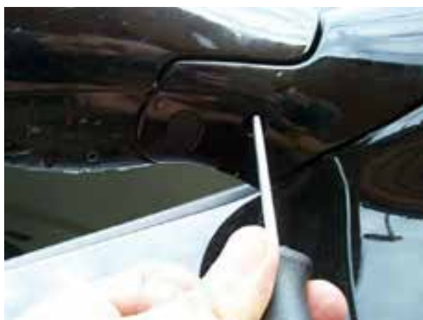
شکل ۱۷۶-۲- بازکردن پیچ روی پایه ی بیرونی آینه
