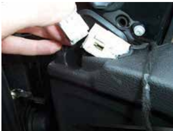
شکل ۱۶۶-۲- جدا کردن سوکت سیم کشی آینه
