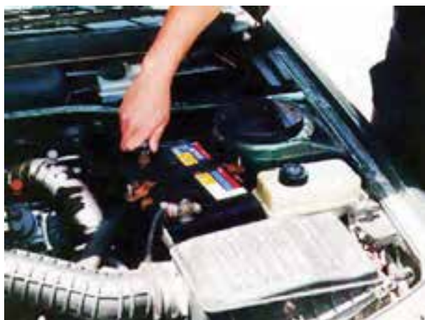
شکل ۱۶۴-۲ بازکردن کابل اتصال بدنه‌ی باتری
