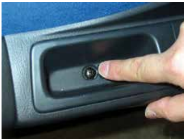
شکل ۱۸۲-۲- پیچ اتصال قاب سوئیچ به بدنه
