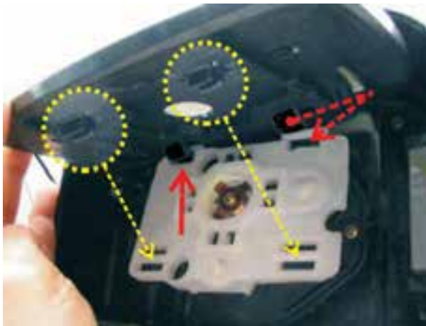
شکل ۱۶۲-۲ زائنده‌ها و خارهای اتصال آینه به صفحه‌ی زیرین
