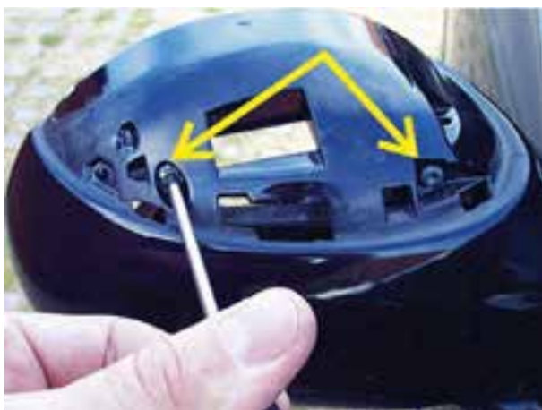
شکل ۱۷۴-۲- بازکردن پیچ‌های قاب بیرونی آئینه
