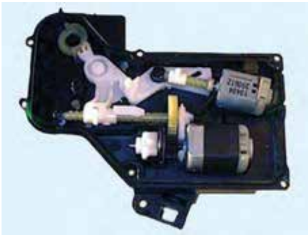
شکل ۱۶۱-۲ مکانیزم انتقال دور در نوعی آینه‌ی جانبی خودرو
