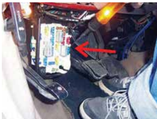
شکل ۱۸۹-۲- آزمایش پایه‌های فیوز
