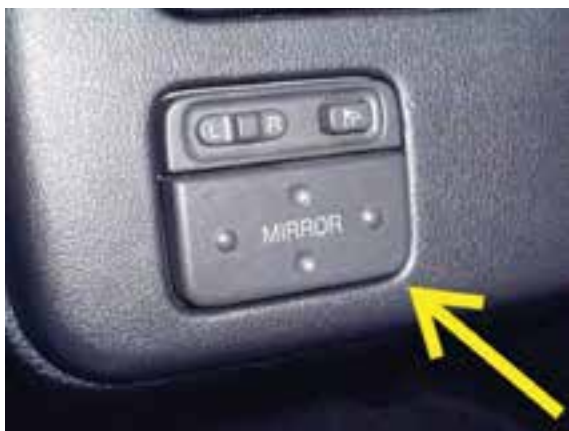
الف – سوئیچ آینه‌های جانبی یک نوع خودرو
