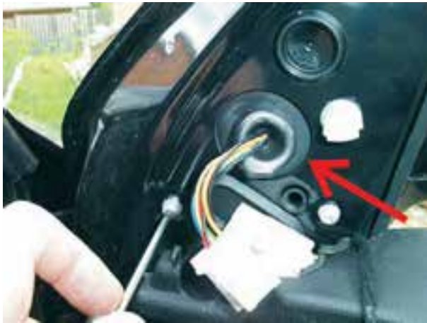
شکل ۱۷۸-۲ – باز کردن پیچ نگه‌دارنده‌ی پایه‌ی اصلی آینه
