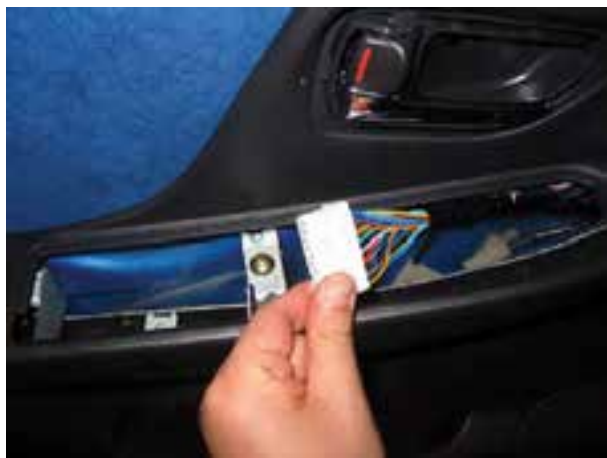
شکل ۱۸۵-۲- سوکت اتصال دسته سیم به سوئیچ‌ها
