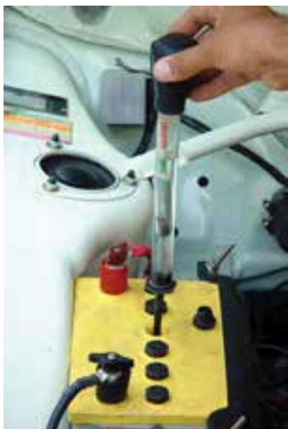
شکل ۲۸-۸ - بررسی دشارژ باتری
