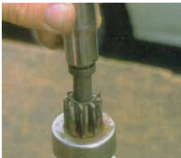
شکل ۸-۶۰ – خارج کردن حلقه رینگی از شیار شافت
