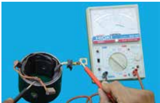
شکل ۸-۷۵- آزمایش اتصال بدنه‌ی بالشتک
