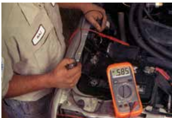
شکل ۸-۴۴- اندازه‌گیری افت ولتاژ پلاتین‌های سولونویید استارتر
