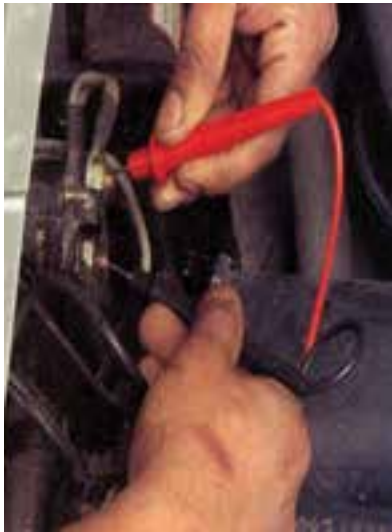
شکل ۸-۴۲- اتصال فیض‌های ولت‌متر به اتومات استارتر
