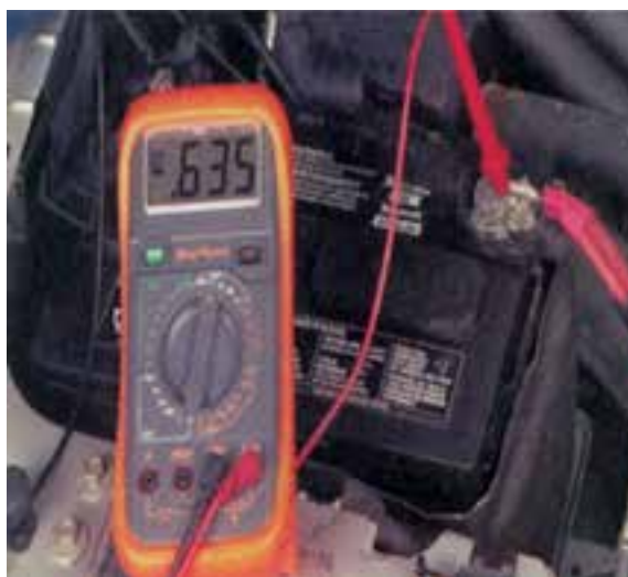
شکل ۸-۳۷ – اندازه‌گیری افت ولتاژ جریان ورودی کابل استارتر
