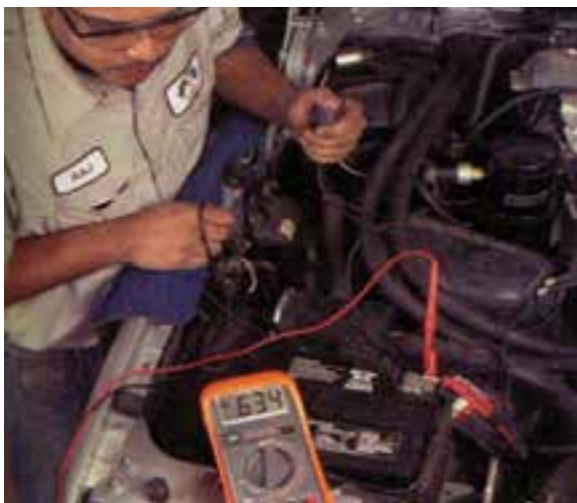
شکل ۸-۳۹- آزمایش افت ولتاژ باتری به خروجی رله
