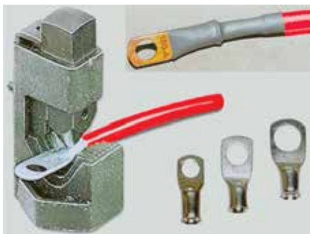
شکل ۸۰-۸- اتصال بست به کابل باتری
