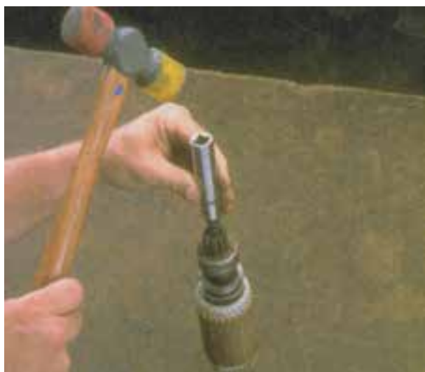
شکل ۸-۵۹ – ضربه زدن با چکش روی خار
