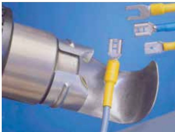
شکل ۷۹-۸- عایق‌کاری اتصال سرسیم به سیم
