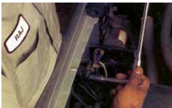
شکل ۸-۴۵ - اندازه‌گیری افت ولتاژ رله‌ی استارتر
