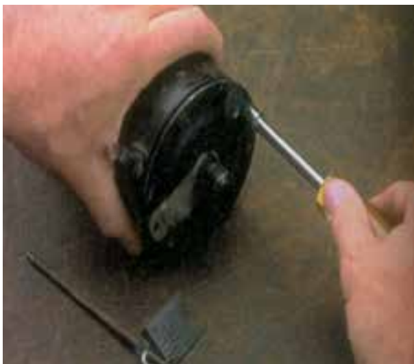
شکل ۸-۵۵ - باز کردن پیچ‌های اتصال درپوش به بدنه
