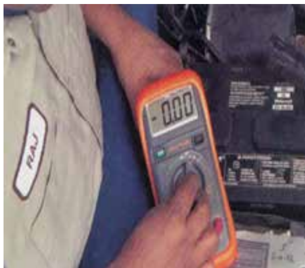
شکل ۸-۳۵- تنظیم مولتی متر روی شاخص ولتاژ
