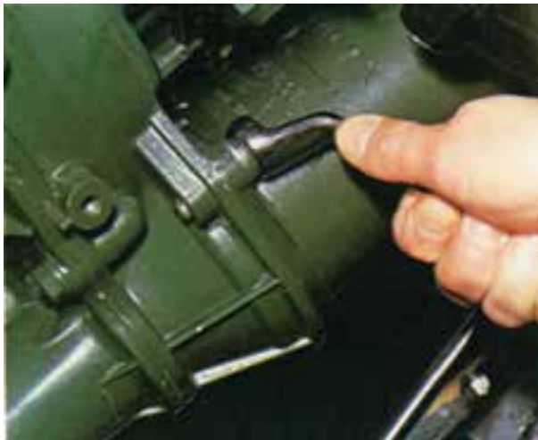
شکل ۸-۷۶- بستن استارتر روی موتور
