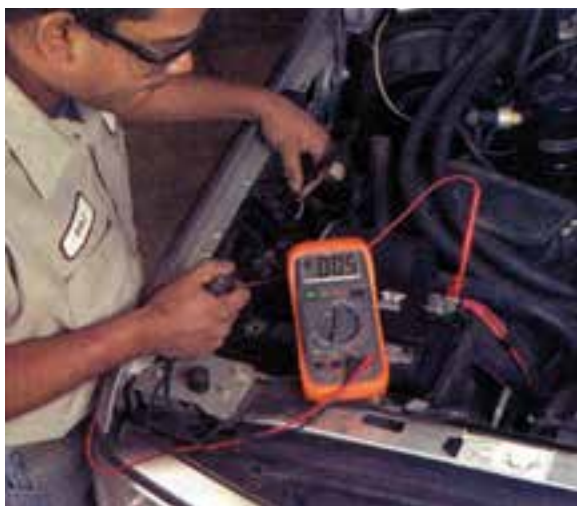
شکل ۸-۴۰- اتصال سیم منفی ولت‌متر به ورودی رله
