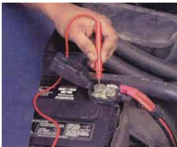
شکل ۸-۳۳- اتصال فیش سرسیم مثبت مولتی متر به قطب مثبت باتری
