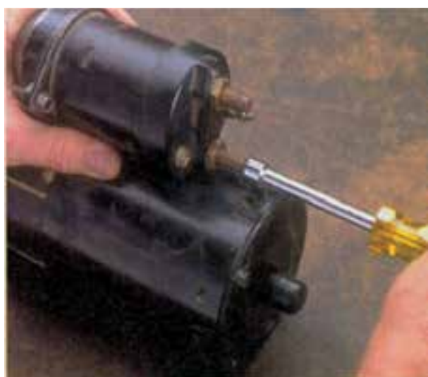
شکل ۸-۵۲ - باز کردن پیچ‌های اتصال اتومات به استارت
