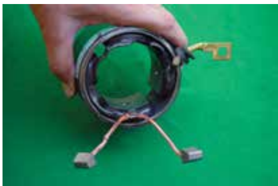
ب- زغال مثبت و محل لحیم آن شکل ۸-۲۲- زغال یا جاروبک استارت
