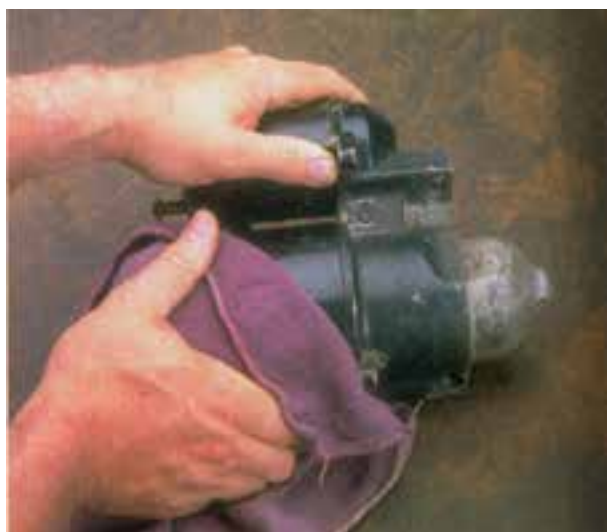
شکل ۸-۵۰ - تمیز کردن استارت
