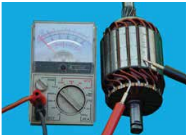
شکل ۸-۶۷- آزمایش اتصال کوتاه شدن آرمیچر
