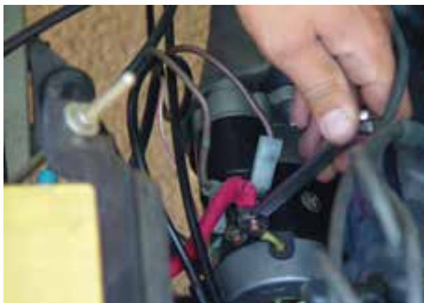
شکل ۸-۴۸- جدا کردن اتصالات الکتریکی استارت
