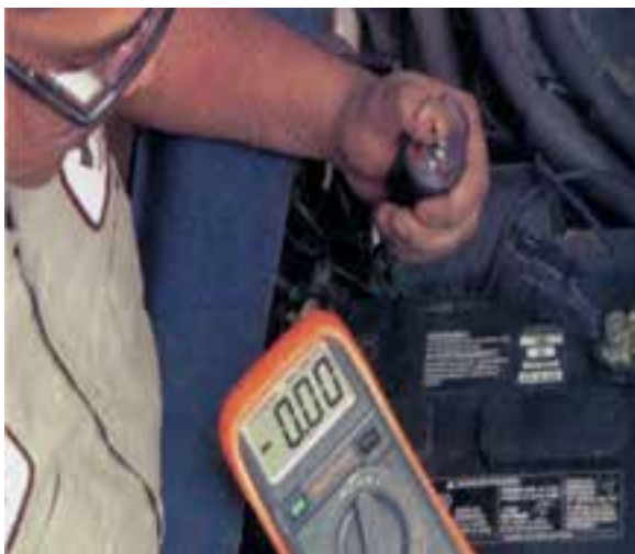
شکل ۸-۳۶ – اتصال سر سیم‌های سوئیچ به ترمینال‌های سوئیچ فشاری
