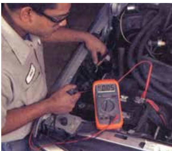
شکل ۸-۴۱- اندازه‌گیری افت ولتاژ کابل متصل به رله
