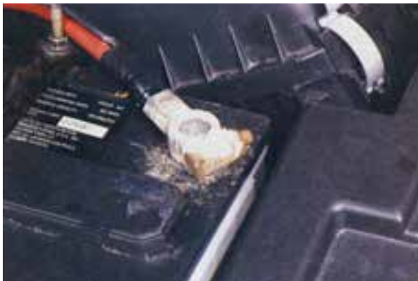
شکل ۳۱-۸ سولفات‌شدن اتصال قطب باتری
