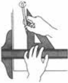
نحوه‌ی خط‌کشی روی لبه‌ی گونیا با مداد در جهت قائم
