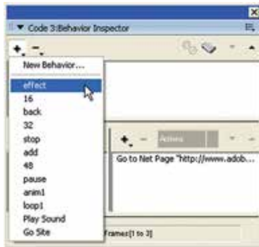
شکل ۷-۷ اضافه کردن یک رفتار آماده از طریق پنجره Behavior
