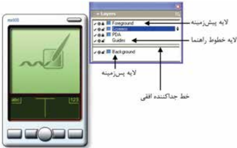
شکل ۱-۱۲ مجزاسازی موضوع ترسیمی در پنل Layer
