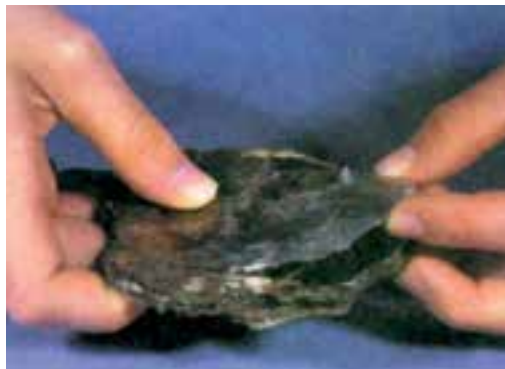
شکل ۱۱-۵- ساختمان ورقه‌ای در میکا
