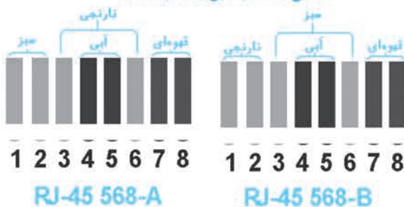
شکل (۳-۱۶) تعریف پایه‌های RJ-45 براساس استاندارد 568A و 568B
