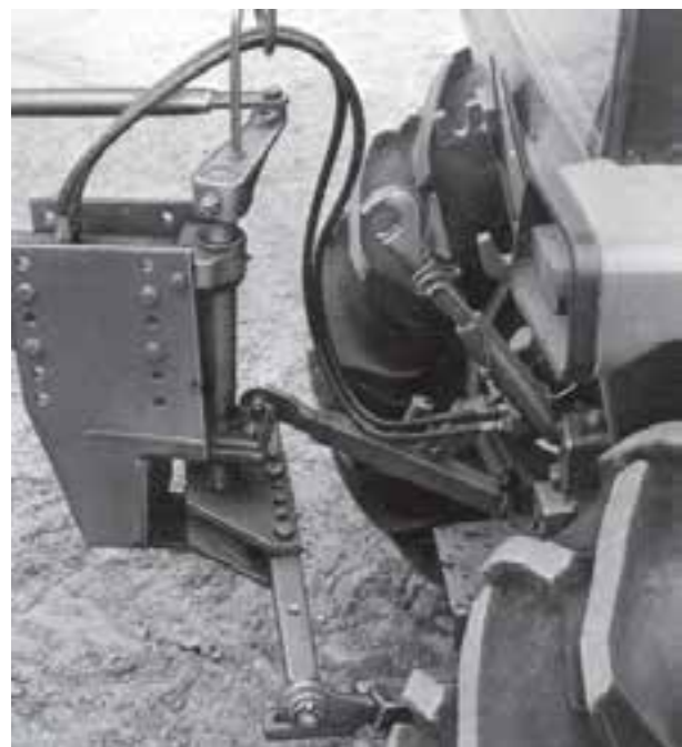
شکل ۲-۷۵- برقراری اتصال بازوها و اتصال هیدرولیکی
