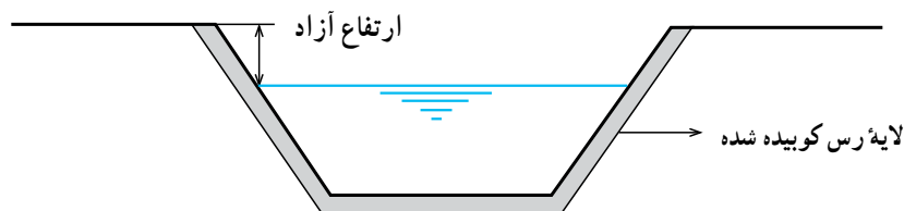
شکل ۱۶-۲- مقطع یک کانال با پوشش خاک رس
