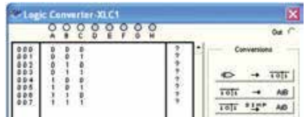
شکل ۲-۲۵ تنظیم جدول صحت روی دستگاه مبدل منطقی
