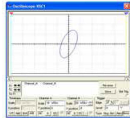
شکل ۴-۳ اختلاف فاز بین جریان و ولتاژ مدار LC سری
