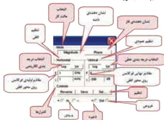
شکل ۴-۵ تنظیمهای دستگاه Bode Plotter
