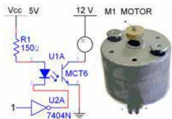
شکل ۷-۲۰ کاربرد جداساز نوری برای راه‌اندازی یک مصرف کننده پر وات
