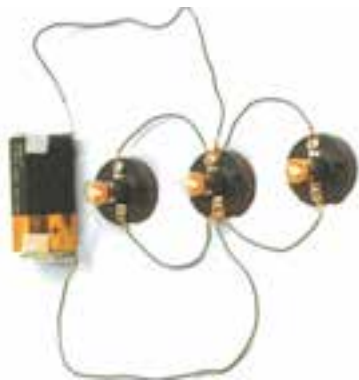
شکل ۱۱-۱- اتصال لامپ ها به باتری به طور موازی
