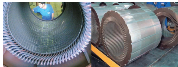
شکل ۳- هسته استاتور، بدنه و سیم پیچ استاتور
