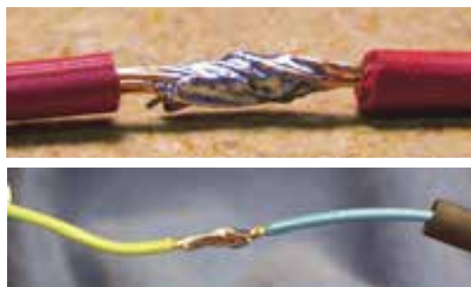
شکل ۱-۵۴- دو نمونه لحیم کاری قابل قبول
