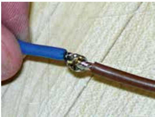
شکل ۱-۵۵- نمونه دیگری از لحیم کاری قابل قبول
