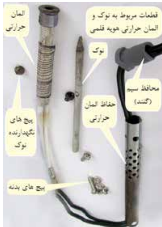
شکل ۱-۲۸- هویه قلمی با نوک و المان قابل تعویض
