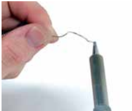
شکل ۴۰-۱- اضافه کردن لحیم به نوک هویه
