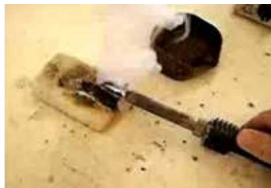
شکل ۳۸-۱- ساده ترین راه تمیز کردن نوک هویه
