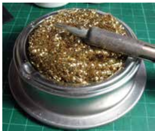
شکل ۱-۴۳- یک نمونه دیگر از اسفنج مخصوص تمیز کردن نوک هویه
