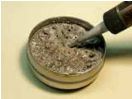
شکل ۳۹-۱- فرو کردن نوک هویه در روغن لحیم
