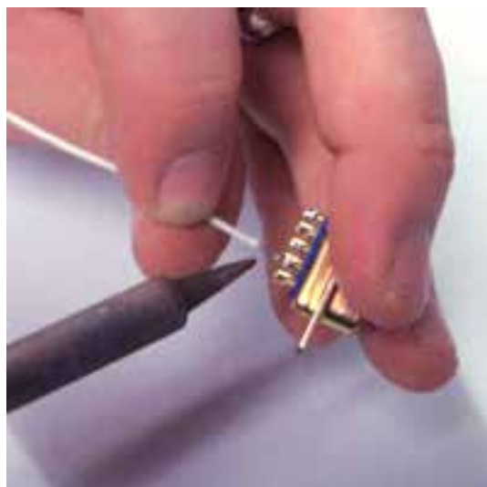
شکل ۱-۵۱- استفاده از دست راست و چپ برای لحیم کاری
