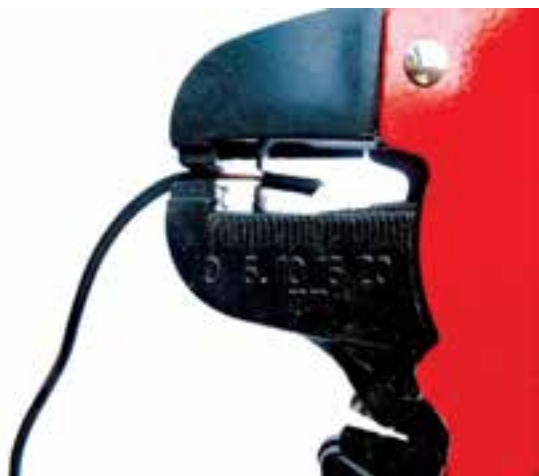
شکل ۱-۴۹- لخت کردن سیم
