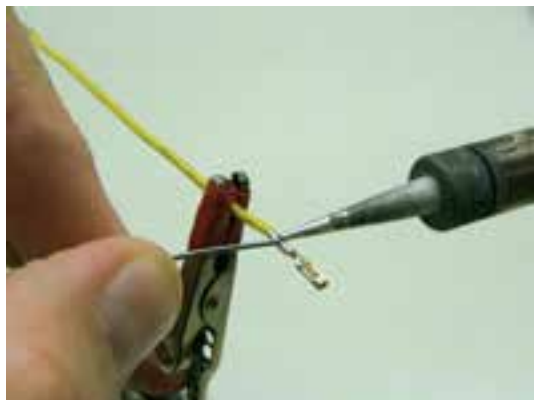
شکل ۱-۵۰- لحیم کاری به کمک گیره
