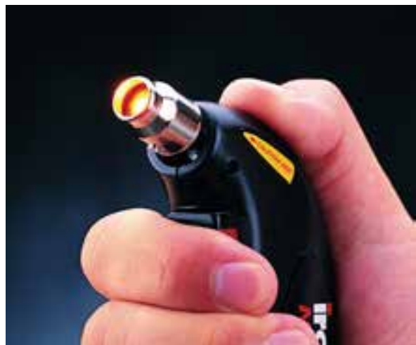
شکل ۱-۶۲- دستگاه گرم کن برای وارنیش حرارتی
