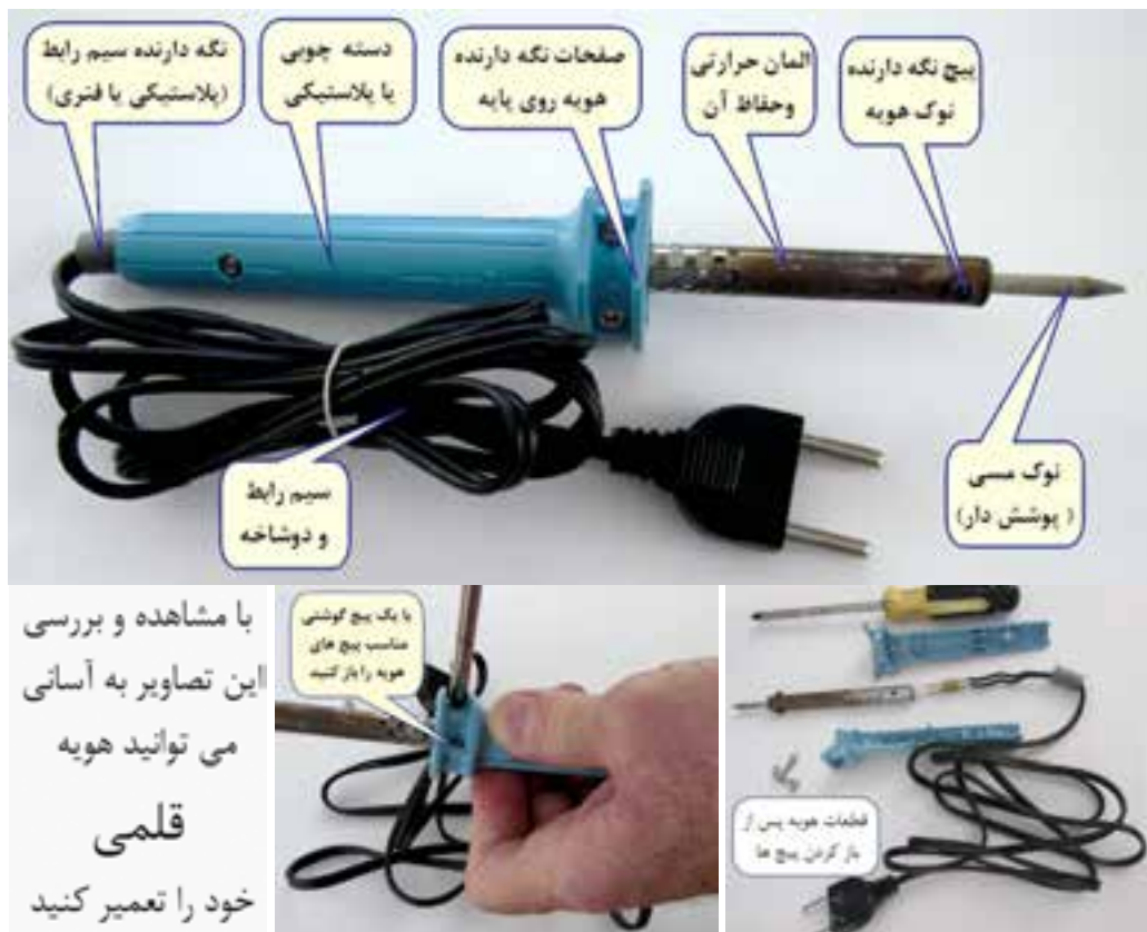
شکل ۲۷-۱- قسمت‌های مختلف یک هویه قلمی
