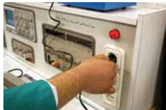
شکل ۱-۲۰- اتصال صحیح دو شاخه
