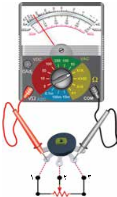
شکل ۱-۳۲ - اندازه‌گیری مقدار کل مقاومت ولوم
