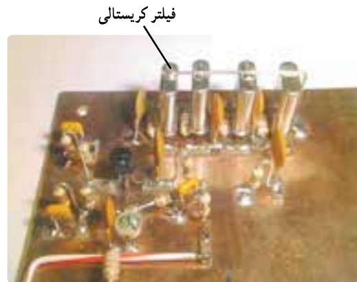
شکل ۱-۳۶- فیلتر کریستالی نصب شده روی مدار
