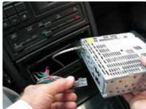
شکل ۲-۲۸- دقت در اتصال سیم‌ها
