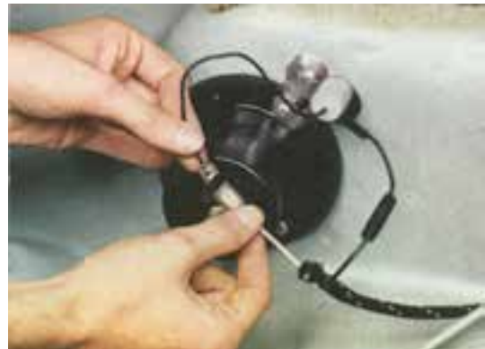
ب- محل پارازیت گیر در مسیر پمپ بنزین الکتریکی
