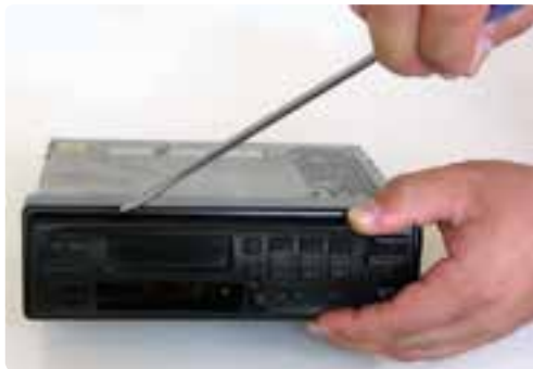
شکل ۲-۳۱- نحوه خارج کردن نادرست قاب
