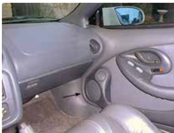
شکل ۲-۱۰- محل نصب بلندگو
