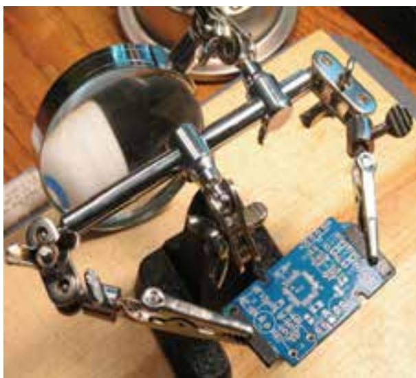
شکل ۱-۷۸- یک نمونه پایه لحیم کاری
