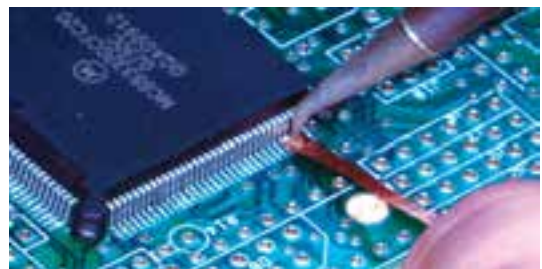
شکل ۱-۷۵- جدا کردن آی سی با فتیله لحیم
