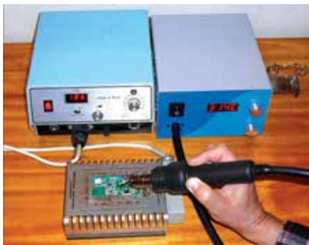
شکل ۸۶-۱- هویه با تنظیم دمای الکترونیکی
