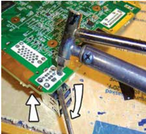
شکل ۱-۷۷- کاربرد قلع کش حرارتی
