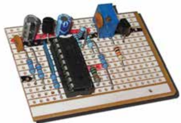
شکل ۱-۱۰۴- یک نمونه مدار کامل روی فیبر سوراخ‌دار
