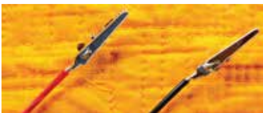
شکل ۱-۹۶- لحیم کاری گیره سوسماری
