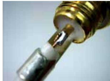
شکل ۱-۹۷- اتصال کابل کوآکسیال به BNC
