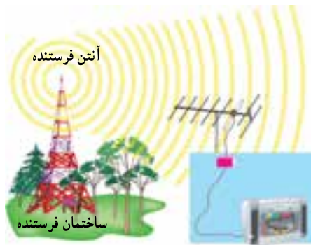
الف- نحوه تشعشع امواج ب- تنظیم جهت آنتن
