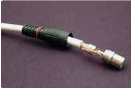
شکل ۴-۱۷- نباید سیم زره و مغزی به هم اتصال کنند.
