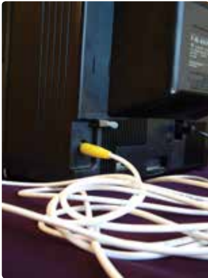
شکل ۴-۱۵- سیم کابل مناسب انتخاب نشده است.
