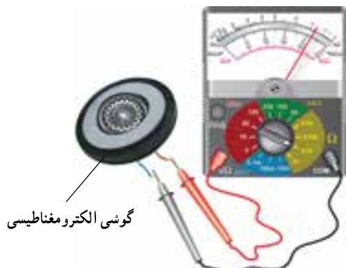
شکل ۵-۱۲- نحوه اتصال گوشی الکترومغناطیسی به اهم متر
