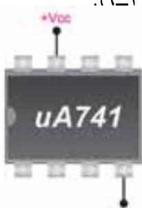
شکل ۹-۱۷- اتصال +V_{CC} و -V_{CC} به آی سی
