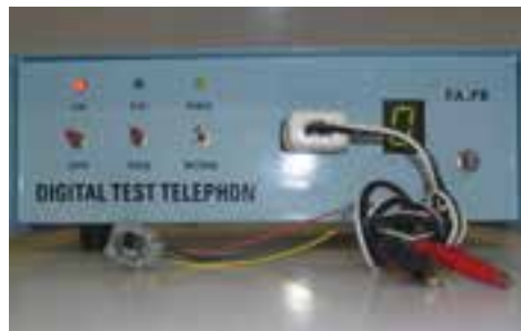
شکل ۱۶-۱۹- نمونه ای از تستر تلفن
