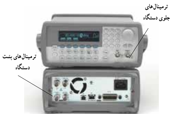
شکل ۲-۱۷- یک نمونه فانکشن ژنراتور مدرن با ترمینال های ورودی در جلو و پشت دستگاه
