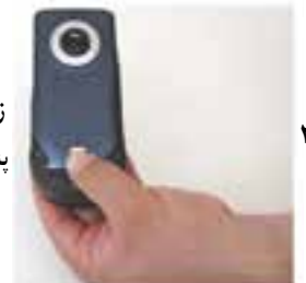
۳ با فشار کمی روی زائنده یا دکمه قاب پشت، قاب را آزاد کنید.
