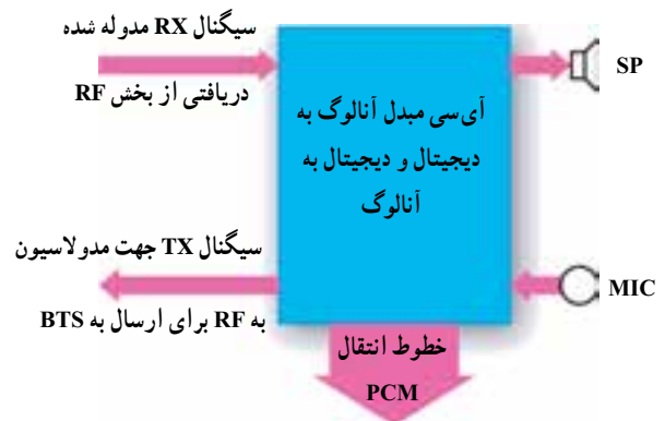
شکل ۲۵-۱۹- ورودی‌ها و خروجی‌های IC در بخش AF
