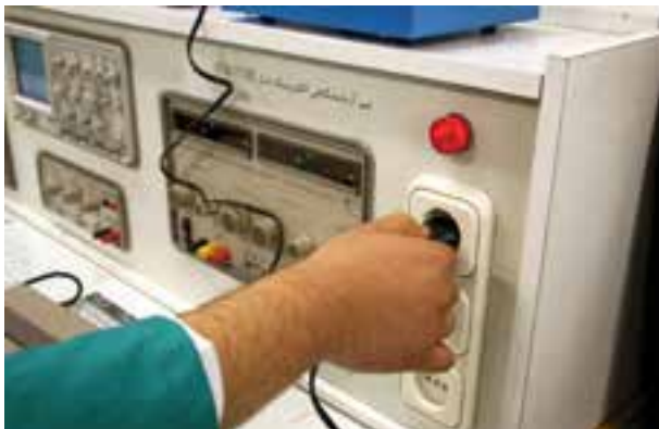
شکل ۱-۷ اتصال صحیح دو شاخه
