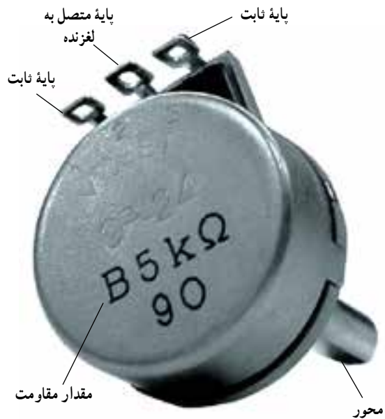
شکل ۳-۳ مقدار نوشته شده روی مقاومت
