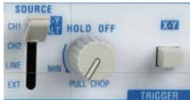
شکل ۶-۱۲ – کلیدهای مرتبط با حالت x y روی یک نمونه اسیلوسکوپ
