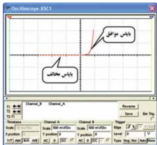
شکل ۷-۱۰ مشخصه ولت آمپر دیود
