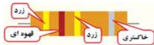
شکل ۲-۷- دیود با نوارهای رنگی
