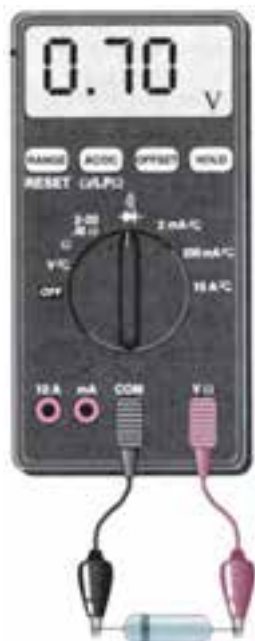
شکل ۹-۷ تعیین پایه ها و جنس دیود با استفاده از مولتی متر دیجیتالی
