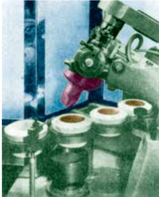
شکل ۳۸-۱- شکل دادن به فنجان با دستگاه رولر
