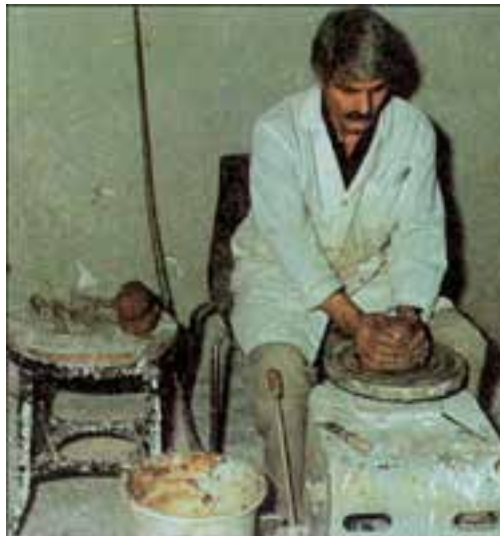
شکل ۴-۱- گل در مرکز چرخ قرار داده می‌شود.
