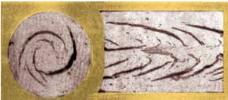
شکل ۲۸-۱- لایه لایه شدن در مقطع گل
