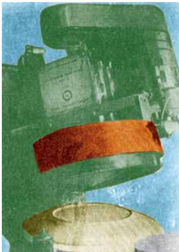
شکل ۳۵-۱- شکل دادن به وسیله‌ی رولر
