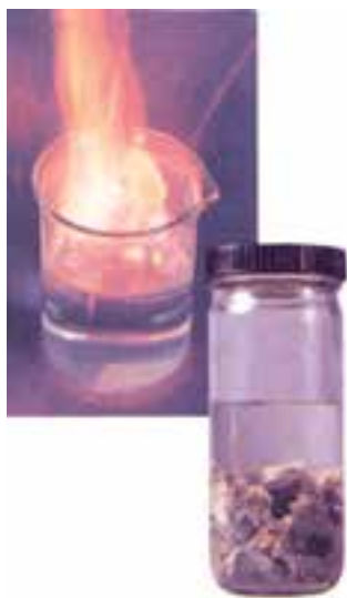
شکل ۱-۳- فلزهای قلیایی را به سبب واکنش‌پذیری بالایی که با آب و هوا دارد، در زیر نفت نگاه می‌دارند.
