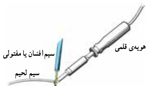
شکل ۲۹-۴- اصول صحیح قلع اندود کردن سرسیم
