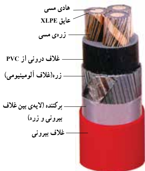
شکل ۳۹-۴ کابل با غلاف آلومینیومی
