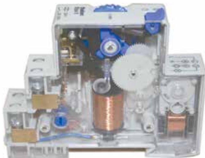
شکل ۵-۲۳- شمایی از یک رله‌ی زمانی
