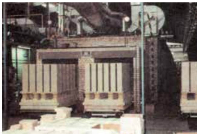
شکل ۴-۵- خشک‌کن تونلی دو قلو برای خشک‌کردن کاشی
