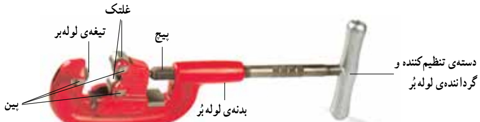
شکل ۱-۲۶- اجزای یک لوله بر فولادی
