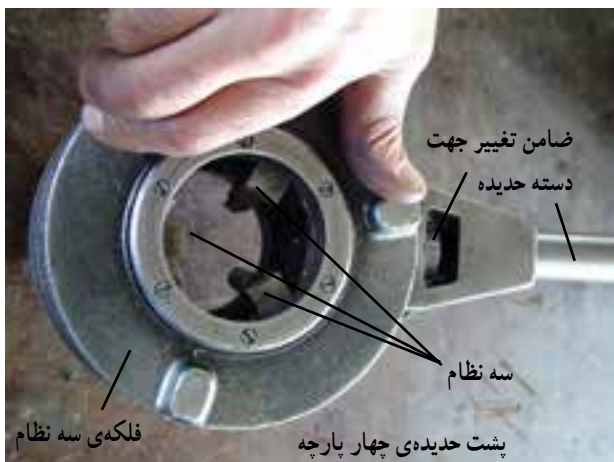
شکل ۱-۳۷-ج - اجزای حديدی چهار پارچه
