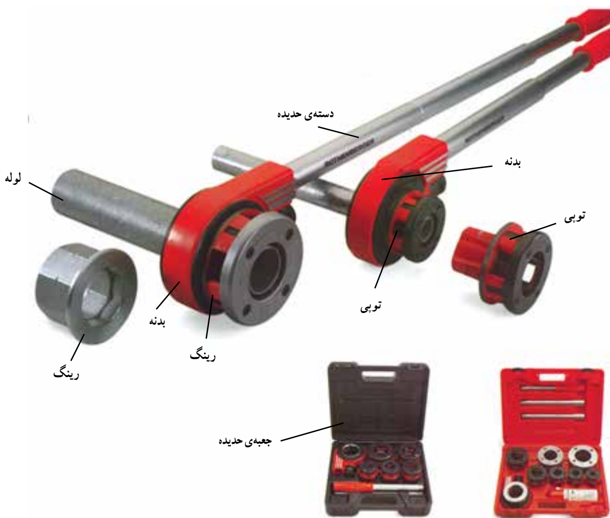
شکل ۳۶-۱- حدیده‌ی چهار بارچه‌ی غیر قابل تنظیم
