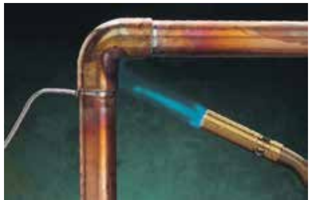
شکل ۴۲-۱- مراحل اتصال لوله‌ی مسی با فیتینگ‌های لحیمی
