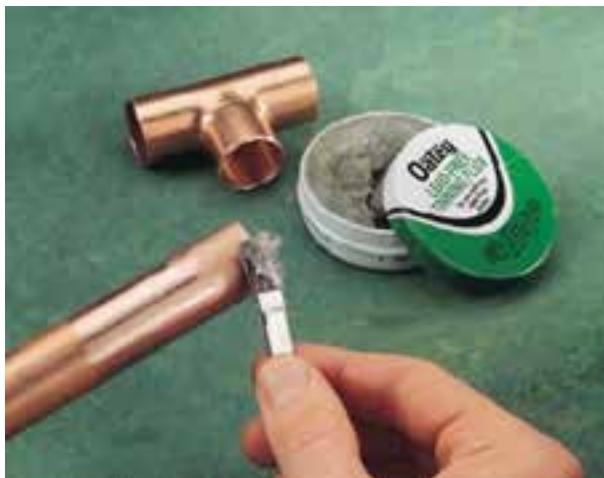
شکل ۴۲-۱- مراحل اتصال لوله‌ی مسی با فیتینگ‌های لحیمی
