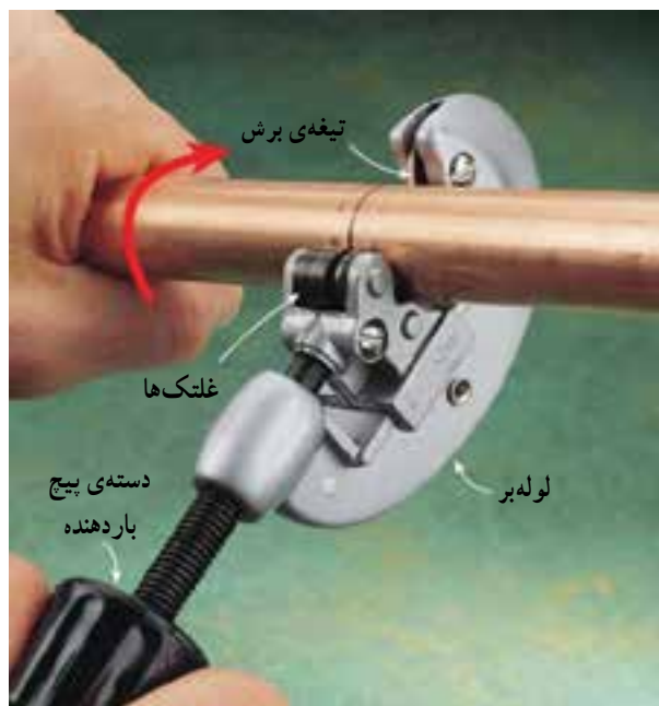
شکل ۱-۱۱- طریقه‌ی بریدن لوله‌ی مسی با لوله‌بر
