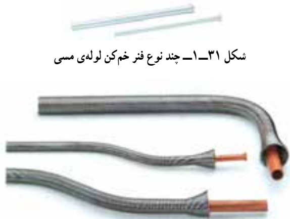
شکل ۱-۳۲- طریقه‌ی خم کردن با استفاده از فنر خم‌کن لوله‌ی مسی
