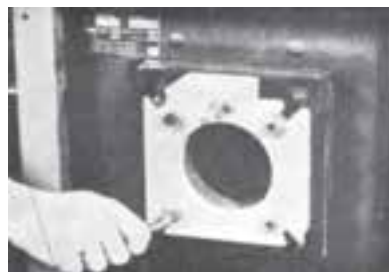
شکل ۲۸-۲- نصب پیچ دو سر دنده و فلنج
