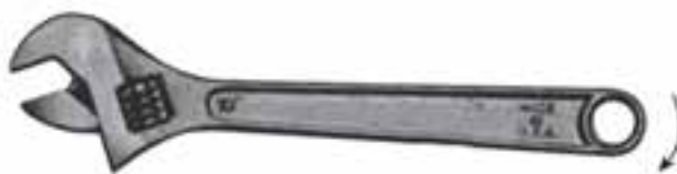
شکل ۱-۵۲- آچار فرانسه، توصیه می‌شود هنگام استفاده از این آچار همواره آنرا در جهت فلش بکشید.
