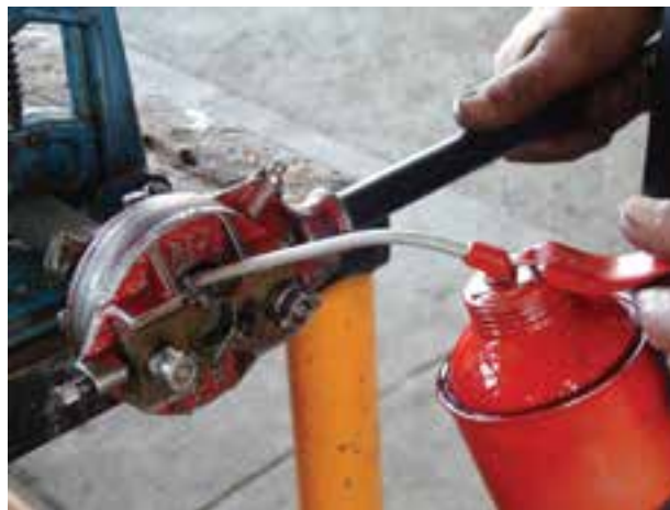
شکل ۱-۴۲ - ریختن روغن برای روانکاری و خنک‌کاری
