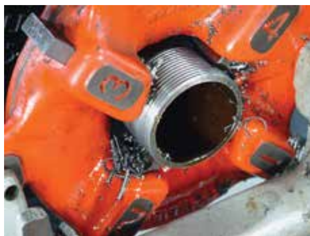
شکل ۱-۴۶- عمل حدیده کاری
