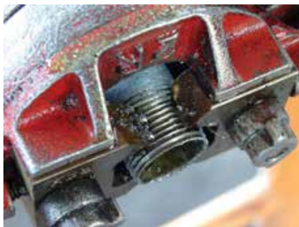
شکل ۱-۴۳ - پایان حدیده‌کاری با عبور دو دندانه از سر لوله
