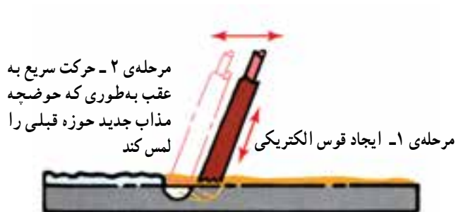
شکل ۳-۴- تشکیل مهره جوش
