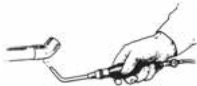
شکل ۲-۱۸- گرم کردن فیتینگ مسی (بیش از حد گرم نشود)
