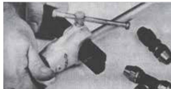
شکل ۲-۲۵- با چرخاندن پیچ (خروسک) لوله بین مرغک و بدنه قرار گرفته و لاله می‌شود.
