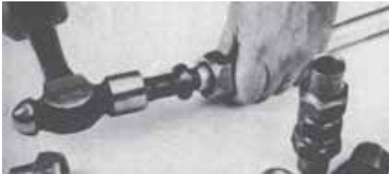
شکل ۲-۲۲- با ضربه‌های ملایم چکش ابزار لاله‌کن را به داخل می‌برند.
