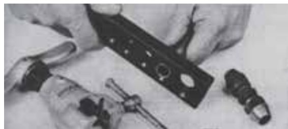
شکل ۲-۲۴- لاله کردن لوله‌ی مسی با لاله‌کن نوع پیچی
