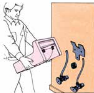
شکل ۲۴-۱۰ مراحل نصب دست‌شویی بدون پایه
