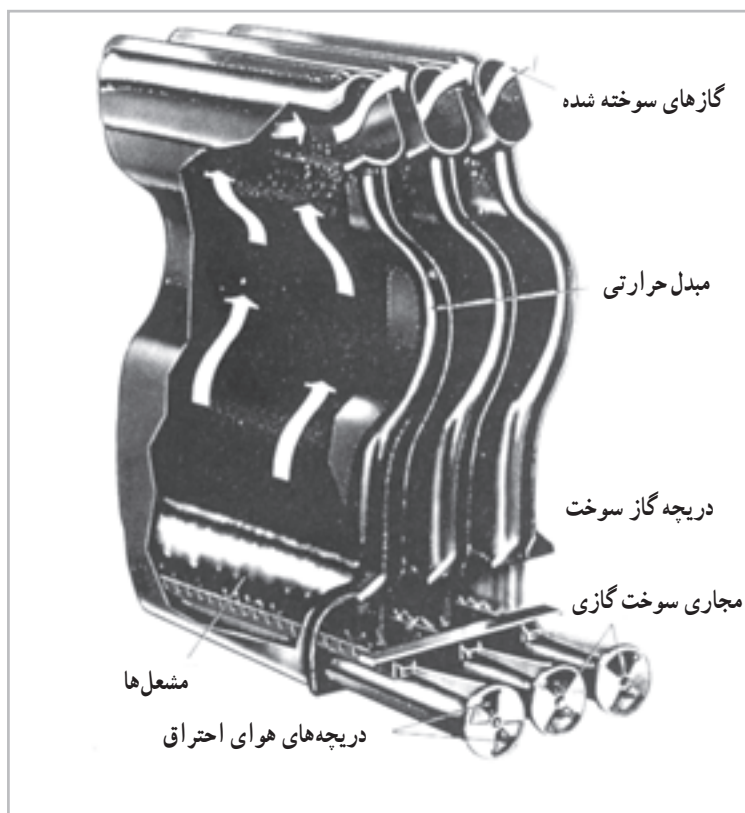
شکل ۴-۱- مبدل حرارتی کوره‌های گازی
