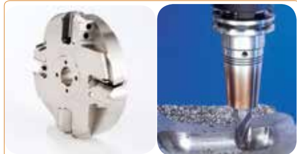
فرم های مختلف هندسی روی قطعات متناسب با شکل هندسی و جهت حرکت ابزارها پدید می آیند.
