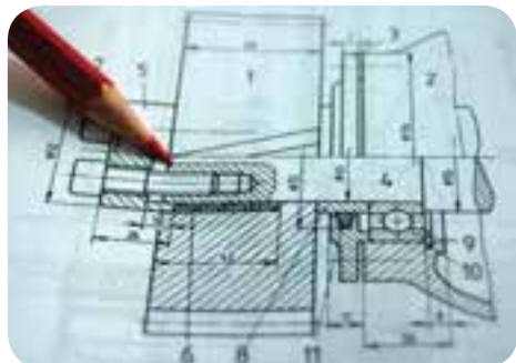
۴- استفاده از اندازه‌های دارای تولرانس و علائم انطباقی در روی نقشه‌ها
