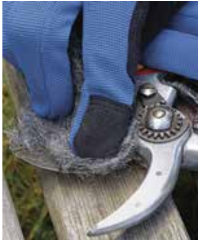
شکل ۱-۱- تمیزکردن قیچی باغبانی با الیاف فلزی
