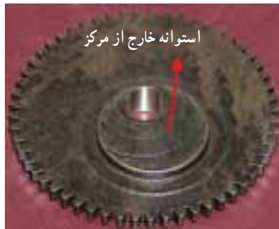
شکل ۲-۳۴ - چرخ دنده بزرگ
