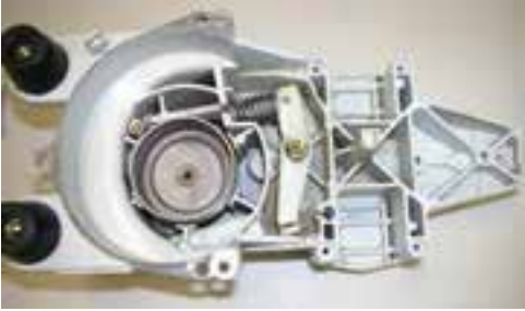
ب - پوسته کلاچ و جعبه دنده
