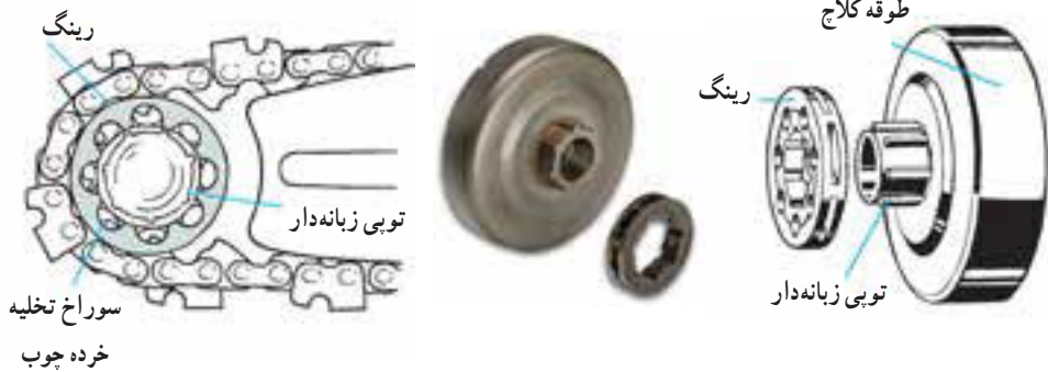
شکل ۷-۲- چرخ زنجیر رینگ‌دار
