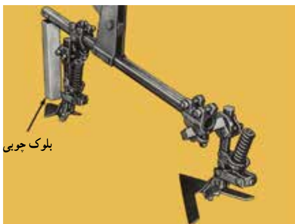
شکل ۱۲-۳- استفاده از قطعه چوب برای تراز پنجه
