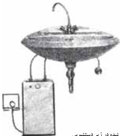
شکل ۲-۵- آبگرمکن نصب شده در زیر دستشویی
