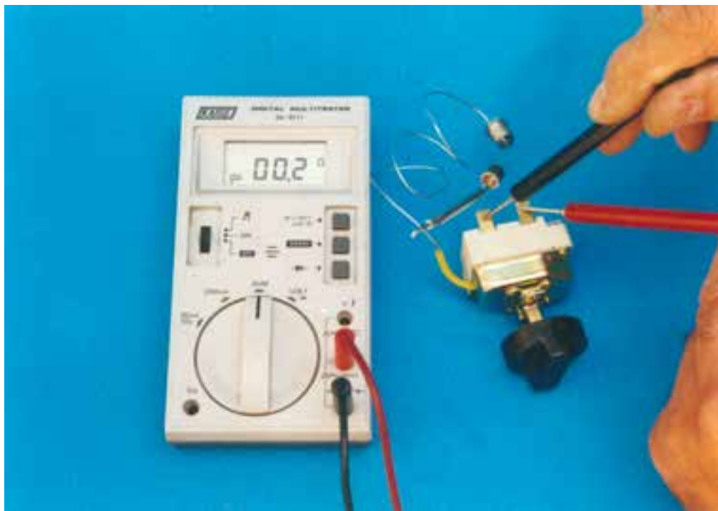
شکل ۴-۲- ترموستات گازی در حال خاموش
