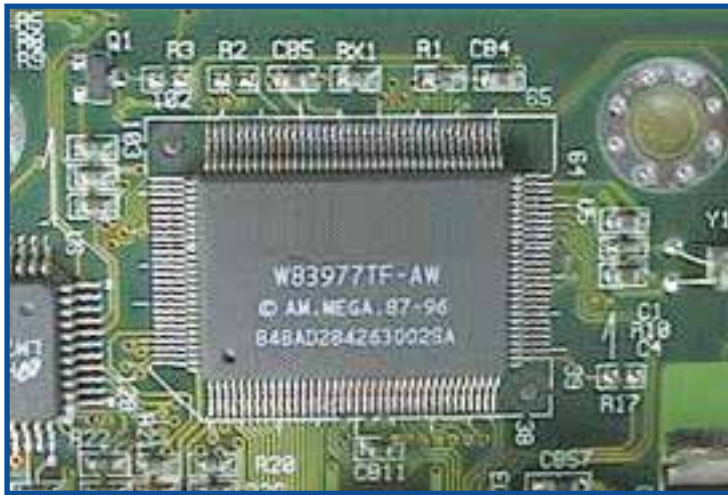
شکل ۳۷-۲ تراشه مجموعه ورودی/ خروجی (Super I/O)
