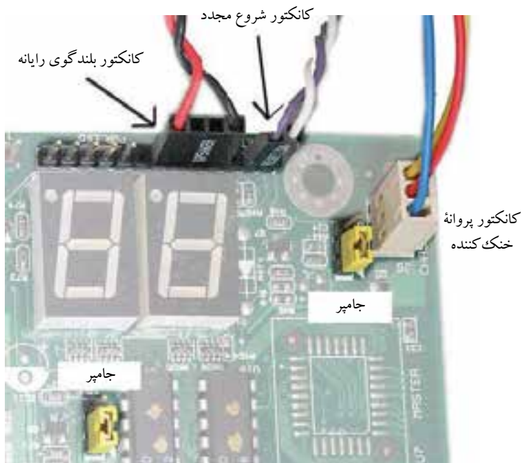
شکل ۱۴-۲ تعدادی از اتصال دهنده‌های روی برد اصلی
