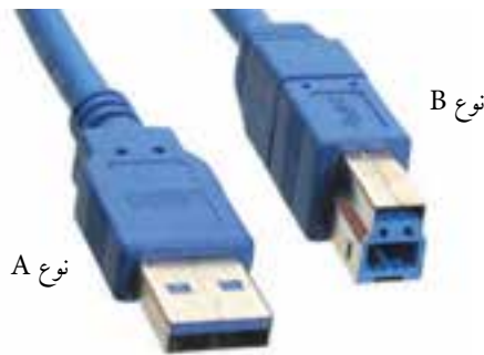
شکل ۳۲-۲ سر کابل‌های رابط USB
