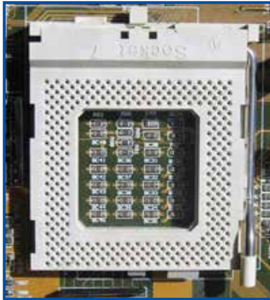
شکل ۲-۶ سوکت پردازنده از نوع ZIF
