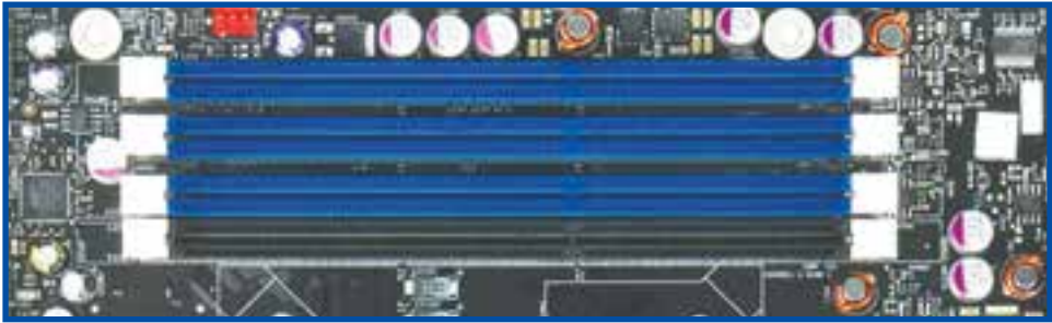
شکل ۷-۲ چهار بانک حافظه DIMM
