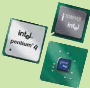
شکل ۲-۴۲ پردازنده پنتیوم ۴ به همراه چیپ i801 اینتل به عنوان MCH
