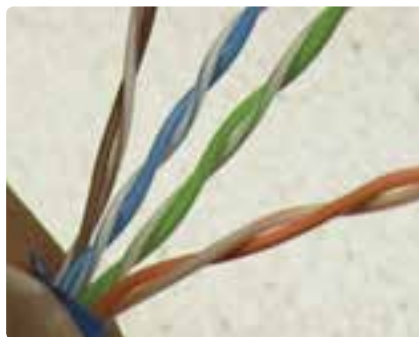
شکل ۴۴-۴- روکش‌برداری از کابل شبکه
