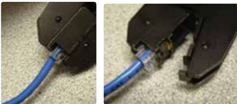
شکل ۴۷-۴- پرس سوکت های کابل شبکه
