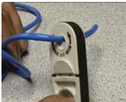
شکل ۴۴-۴- روکش‌برداری از کابل شبکه
