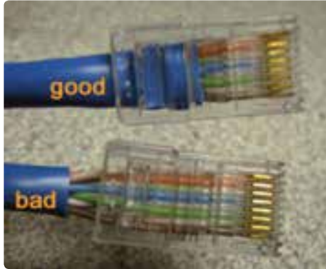
شکل ۴۸-۴- روکش برداری مناسب و نامناسب کابل‌های شبکه
