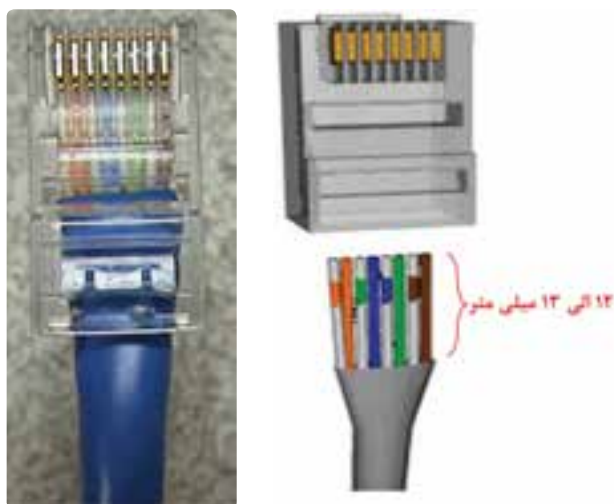
شکل ۴۶-۴- سوکت زدن به سر کابل
