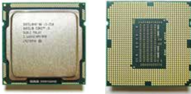
شکل ۳-۴۰ جلو و پشت پردازنده Intel Core i5-750
