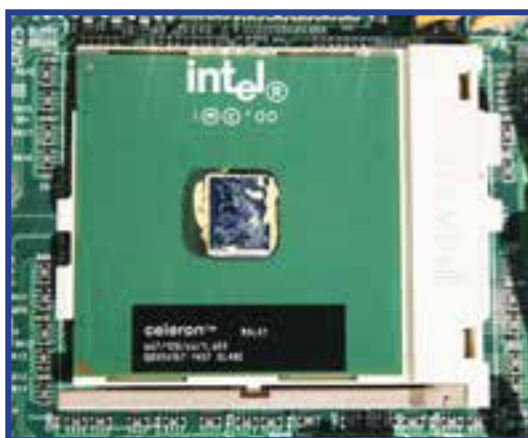
شکل ۳۲-۳ پردازنده سلرون و سوکت ۳۷۰ PGA
