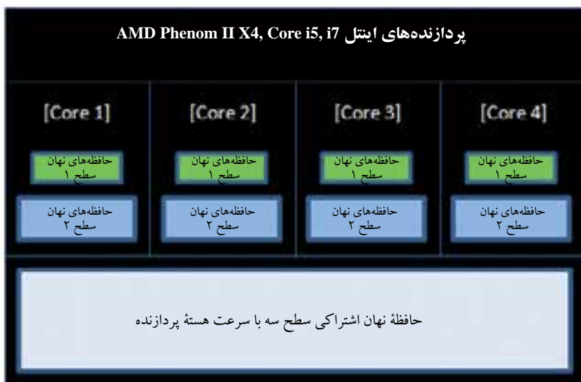
شکل ۴۲-۳ پردازنده‌های چهار هسته‌ای با حافظه نهم سطح سه اشتراکی
