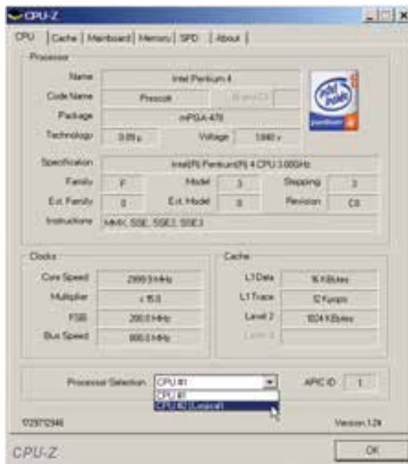
شکل ۶-۳ نمایش مشخصات پردازنده با نرم افزار CPU-Z
