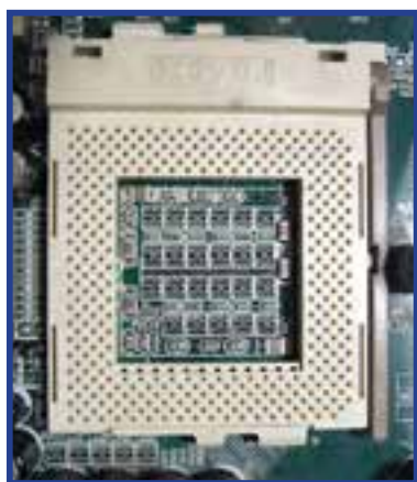
شکل ۳۲-۳ پردازنده سلرون و سوکت ۳۷۰ PGA
