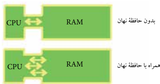
شکل ۱۵-۳ مقدار تبادل داده ما بین پردازنده و حافظه اصلی با حافظه نهان و بدون آن
