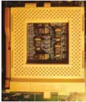
شکل ۲۸-۳ پردازنده پنتیوم ۷۵ و سوکت شماره ۵
