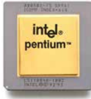
شکل ۲۸-۳ پردازنده پنتیوم ۷۵ و سوکت شماره ۵
