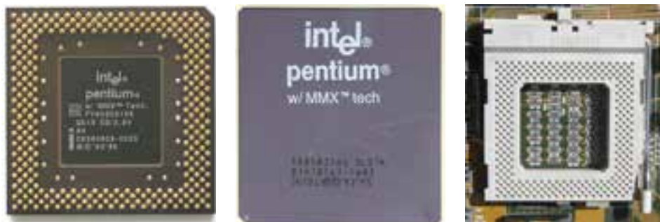
شکل ۲۹-۳ نمای جلو و پشت پردازنده پنتیوم MMX ۱۶۶ و سوکت شماره ۷
