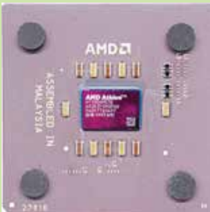
شکل ۳-۳۴ پردازنده AMD Athlon در سمت چپ و پردازنده AMD Duron در سمت راست
