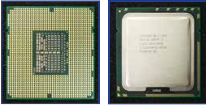
شکل ۳۷-۳ جلو و پشت پردازنده Intel core i7-975
