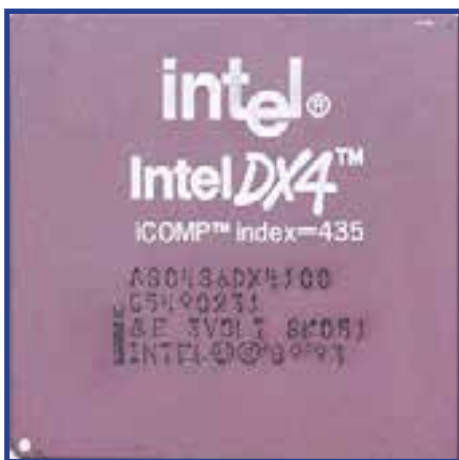
شکل ۲۲-۳ پردازنده ۴۱۰۰ DX ۴۸۶ با سرعت ۱۰۰ مگاهرتز و سوکت شماره ۳
