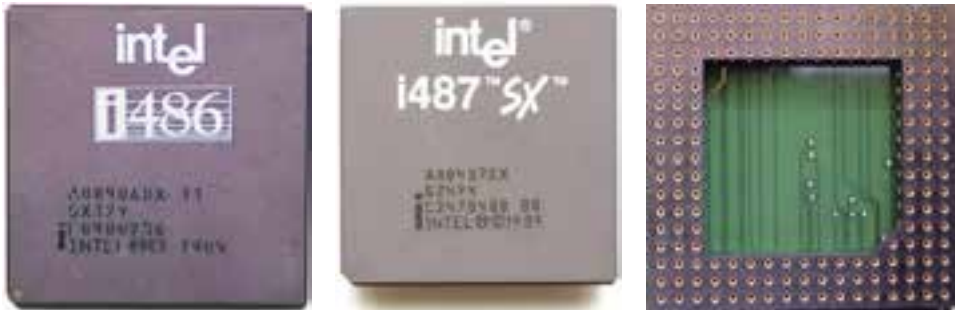
شکل ۲۲-۳ پردازنده ۸۰۴۸۶ DX محصول شرکت اینتل با فرکانس پالس ساعت ۳۳ مگاهرتز، کمک پردازنده اولیه ۸۰۴۸۷ و سوکت شماره یک
