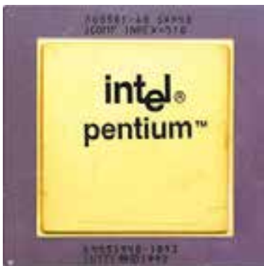
شکل ۲۶-۳ پردازنده ۸۰۵۸۶ معروف به پنتیوم محصول شرکت اینتل با فرکانس پالس ساعت ۶۶ مگاهرتز و سوکت شماره ۴
