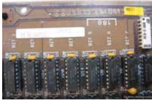
شکل ۹-۴ نوعی حافظه DIP که روی برد اصلی لحیم می‌شدند.
