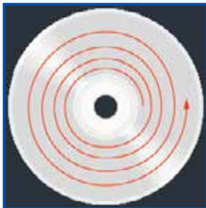
شکل ۳۵-۴ شیار دیسک فشرده
