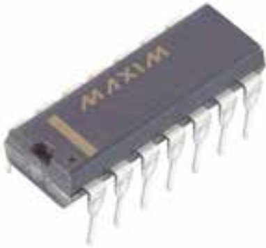
شکل ۹-۴ نوعی حافظه DIP که روی برد اصلی لحیم می‌شدند.
