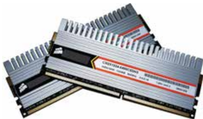
شکل ۱۷-۴ حافظهٔ اصلی DDR2 با ظرفیت یک گیگابایت و فرکانس پالس ساعت ۸۰۰ مگاهرتز
