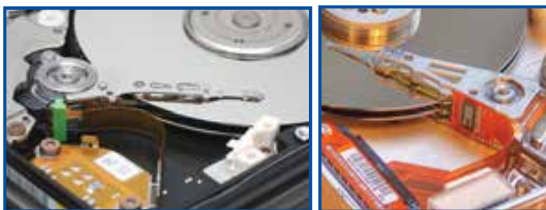
شکل ۳۱-۴ هد خواندن و نوشتن در دیسک سخت با دو صفحه
