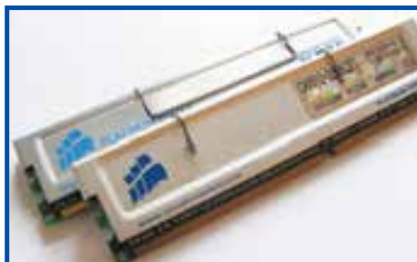
شکل ۱۶-۴ ماژول حافظه DDR SDRAM با ظرفیت ۵۱۲ مگابایت و فرکانس ساعت ۴۰۰ مگاهرتز
