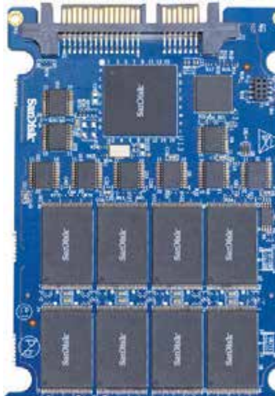
شکل ۴۱- حافظه نیمه‌هادی و مجموعه‌ای از تراشه‌های حافظه فلش
