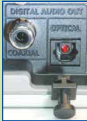
شکل ۲۷-۵ ورودی کابل نوری و کابل هم‌محور بر روی بلندگو
