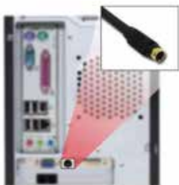
شکل ۵-۱۱ کانکتور (S-Video) به رنگ مشکی و کانکتورهای رنگی دیگر، جهت اتصال به تلویزیون
