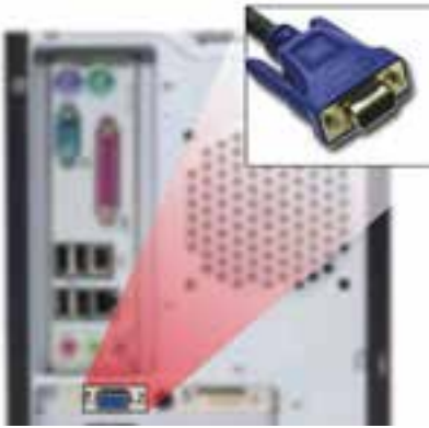
شکل ۱۵-۵ درگاه خروجی ۱۵ پین VGA برای اتصال به صفحه‌نمایش‌های آنالوگ
