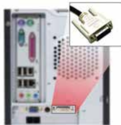
شکل ۱۷-۵ درگاه DVI برای اتصال به صفحه‌نمایش‌های دیجیتال
