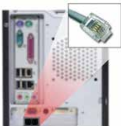
شکل ۳۱-۵ محل اتصال کابل‌های مودم به پشت کیس مربوط به مودم‌های داخلی و پریز تلفن
