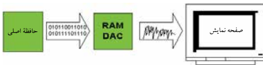
شکل ۵-۸ عملکرد تبدیلی مدار DAC
